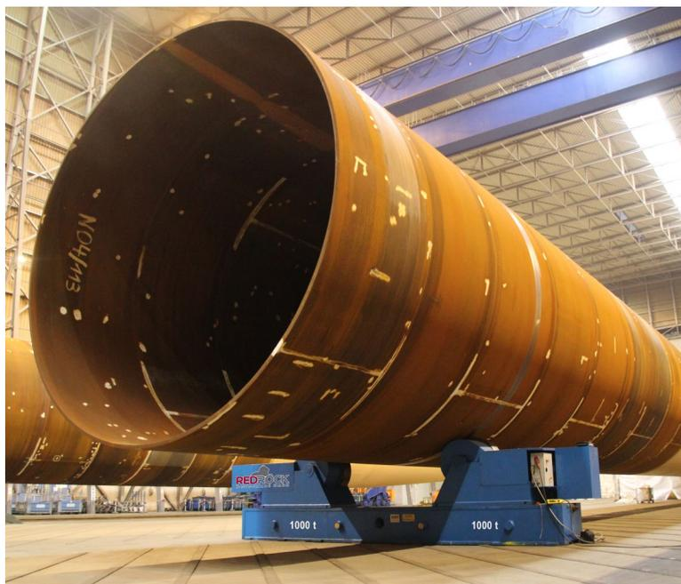
1.000t-Behälterdrehvorrichtungen in der Offshore-Wind-Fertigung
