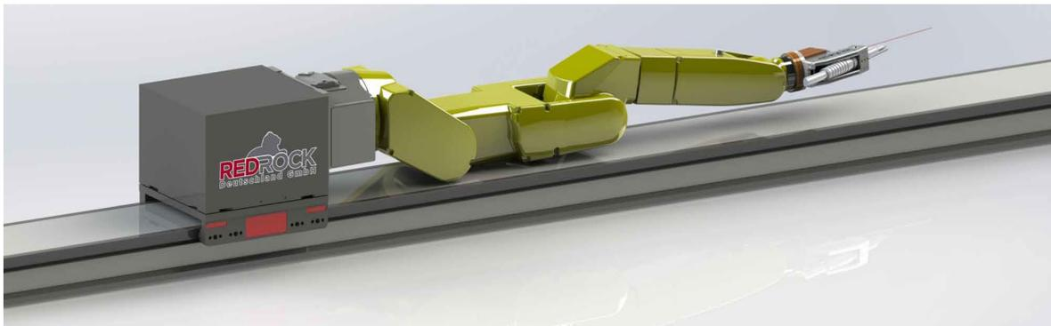
Abbildung zeigt mannlochfähiges Roboter-Schweißsystem für den Schiffbau
